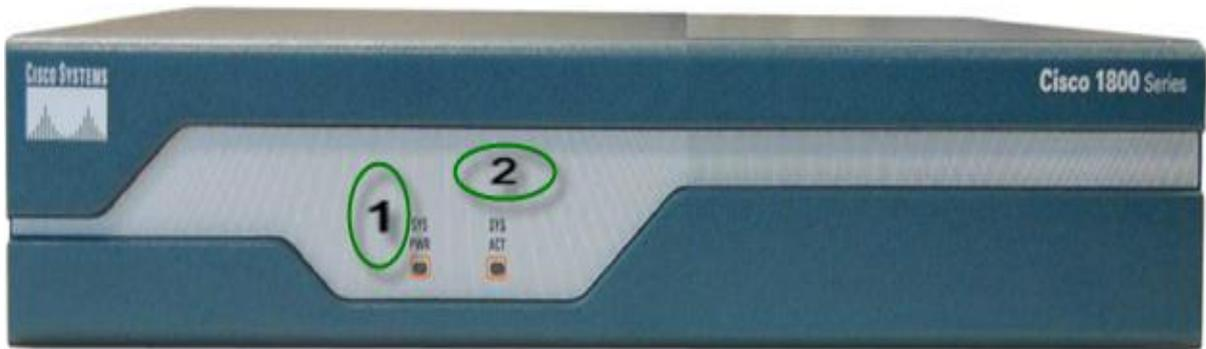
1. ضوء نظام الطاقة (LED) : عندما نقوم بتوصيل كابل جهاز الراوتر بالكهرباء يكون لونه اخضر
