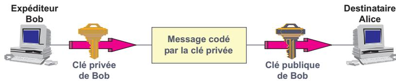
Figure 17.14 Principe du PGP.
