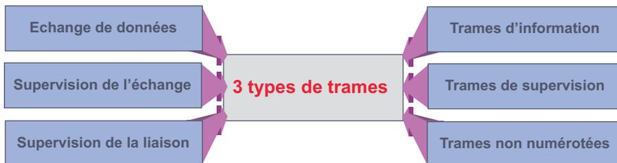
Figure 6.40 Les fonctions et trames correspondantes d'HDLC.
