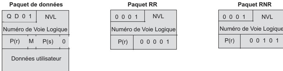
Figure 11.41 Format des paquets de données, d'acquittement et de contrôle de flux.
