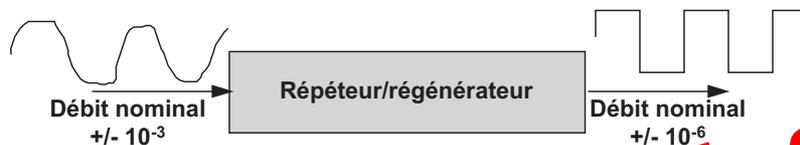
Figure 11.5 Régénération du signal par un répéteur.
